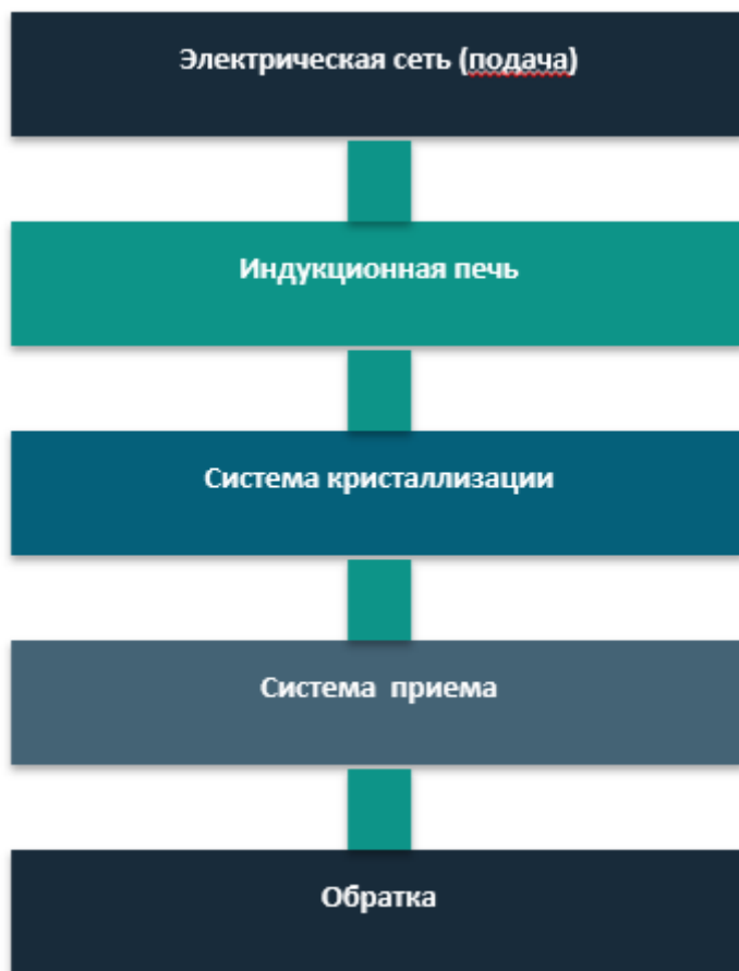
Рис. 5. Система независимого подключения Индукционной печи
