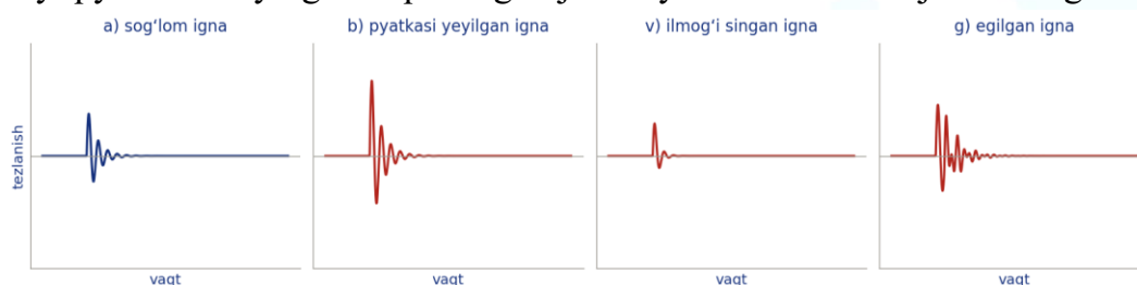
2-rasm. Zarb impulsi shaklining nuqson turiga qarab o'zgarishi (sifat ko'rinishi, nazariy mulohazalar asosida tuzilgan)
