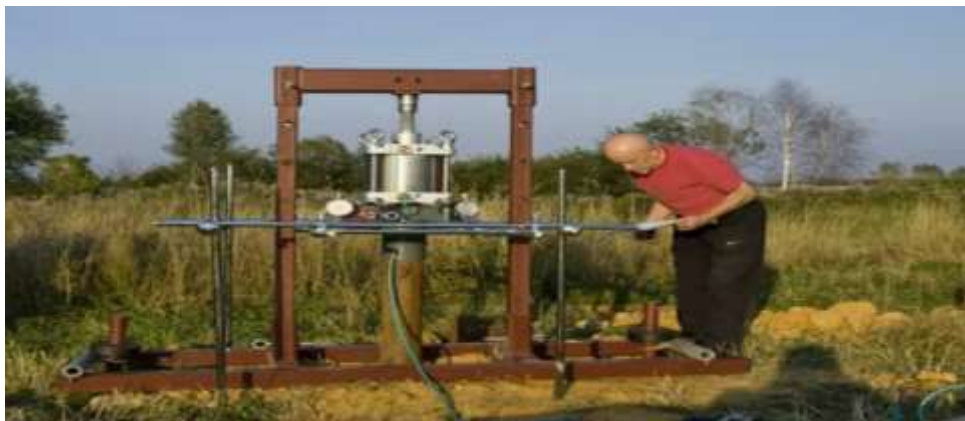
4-rasm. Gruntlarning siqilishini aniqlovchi kompression asbob
