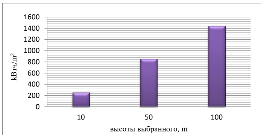
Рис.3. Среднегодовое значение для измеренных по распределению Вейбулла удельной мощности ветра на выбранных высотах.
