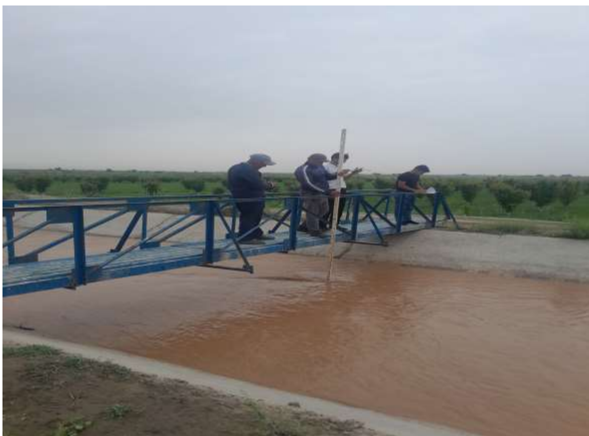
1-rasm. Muallif tomonidan Chovkar kanali gidropostida birlamchi gidrometrik o‘lchash ishlarini olib borish jarayoni.(Chovkar kanalida oqim tezligini aniqlash ishlari muallif tomonidan bevosita dala sharoitida amalga oshirildi)
