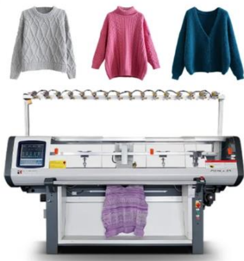
1-rasm. Yassi ignadonli trikotaj to‘quv dastgohi
