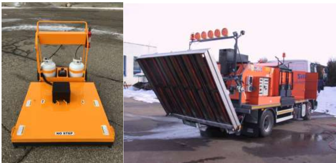
1-rasm: Infraqizil nurlarda asfaltbeton qoplamasini isitgich qurilmasi va mashinasi.
