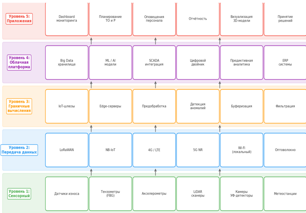
Рис. 1. Многоуровневая архитектура IoT-системы мониторинга контактной сети
