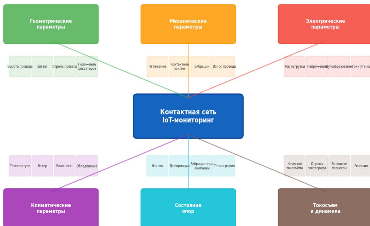
Рис. 2. Классификация параметров, контролируемых IoT-системой мониторинга контактной сети
