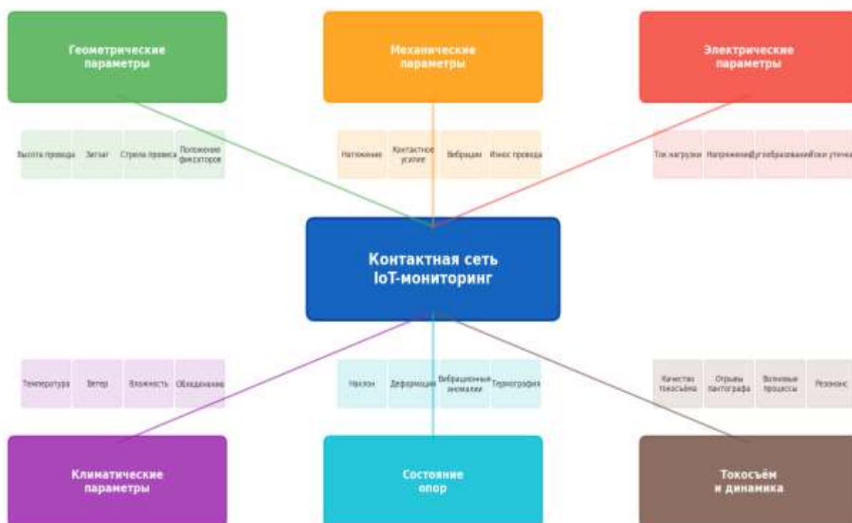
Рис. 2. Классификация параметров, контролируемых IoT-системой мониторинга контактной сети
