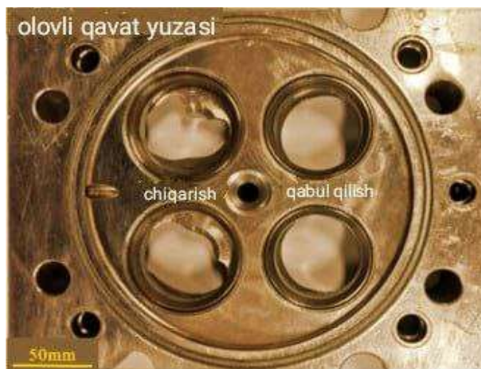
1-rasm. Nosozlikdan keyin dizel dvigatel silindr qopqog'i.
