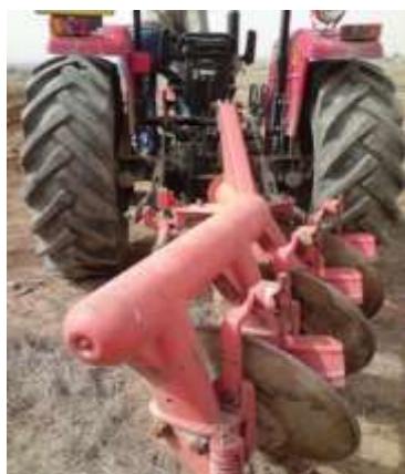
2-rasm. Qirg'ich bilan jihozlangan diskli plugning MF traktori bilan agregatlangan umumiy ko'rinishi
