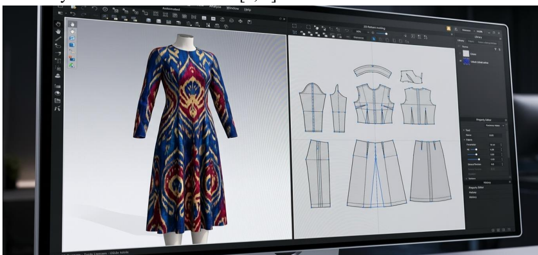
1-rasm. CLO 3D dasturiy muhitida milliy adras libosining 3D virtual simulyatsiyasi (chapda) va 2D andozalar konstruksiyasi (o'ngda)
