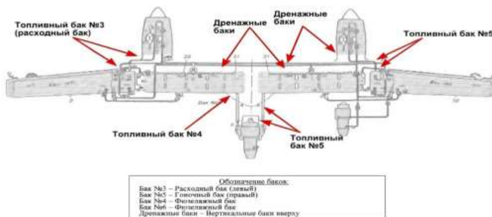
Рис. 7.2-1-расм. Топливные баки: точное изображение и расположение
